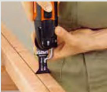
利用深度限制裝置，所有用E型精確木鋸片和高速鋼(HSS)扇形木鋸片加工的木材切割深度都可無級設置和調節。
