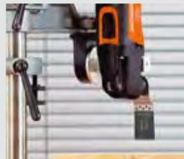
適用於所有常用鑽杆的組合式固定器能精確地開槽和切割。通過鑽杆的機械原理，可精確地進行工作。
