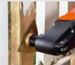
利用硬金屬打磨銑可以徹底除去頑固的風化剝蝕痕跡—通過更高的磨除功率使除去風化剝蝕痕跡的工作特別迅捷。
