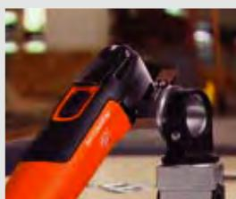
您可採用新型臺式和鑽杆固定器固定FEIN MULTIMASTER，由此實現加工件的精確加工。
