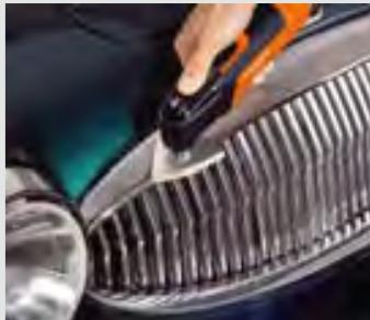
毛氈拋光墊套件能使塗漆和鑄面重新恢復高光潔度—它也同樣能使木材和石材表面形成高光潔度。
