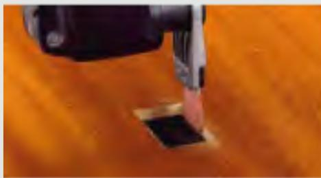
使用迷你切割套裝 (MINICUT) 和銼刀套件用的新型硬金屬銼刀部件可乾淨地銼出溝槽，並可在木材和塑膠的加工中完整地去除毛刺。
