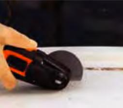
高速鋼(HSS)鋸片特別適用於GFK材料（玻璃纖維增強塑膠）或CFK材料（碳纖維合成材料）船體的鋸割工作。層壓塑膠板不會在加工中產生裂縫、受到損傷，切割效果完美（0.5 mm寬）定會使您稱心如意，倍感欣喜。
