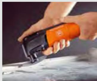
使用高速鋼(HSS)扇形鋸片可非常簡單地、在沒有玻璃破碎危險的情況下除去易碎的粘膠纖維。
