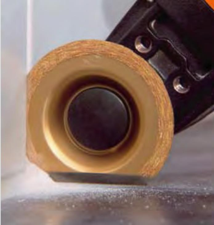
扇形鋸片可用於去除邊角處的受損瓷磚縫隙灰泥，它的運用能在不影響周圍瓷磚的情況下實現精確切割。扇形鋸片有硬金屬和金鋼石質量的產品可供選擇—金鋼石質量的鋸片由於具有更長的耐用壽命而令人信服，它也適用於室外應用領域中防霜凍、含有環氧樹脂的縫隙灰泥材料或者用於瓷磚縫隙灰泥的更換。
