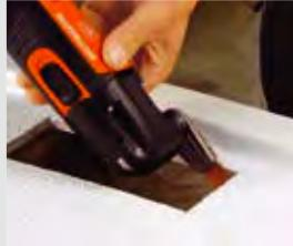
使用迷你切割套裝(MINICUT)和銼刀套件可將開槽精確地銼成型。
