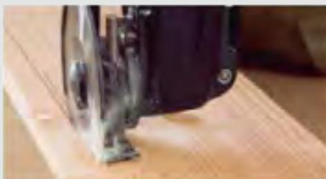
可用于完美地切割已經鋪設的鑲木地板、層壓塑膠板或護壁板：這種圓的高速鋼 (HSS) 鋸片使 FEIN MULTIMASTER 成為一種擺動型“微型圓鋸”。
