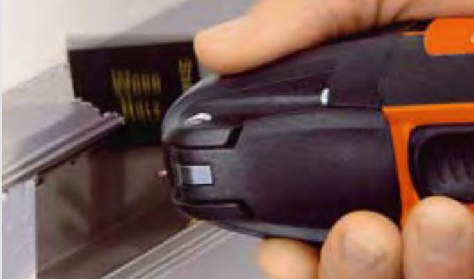
塑膠建築部件，如電線槽、排氣管道或雨水收集管道可用標準E型精確鋸片理想地進行加工處理。
