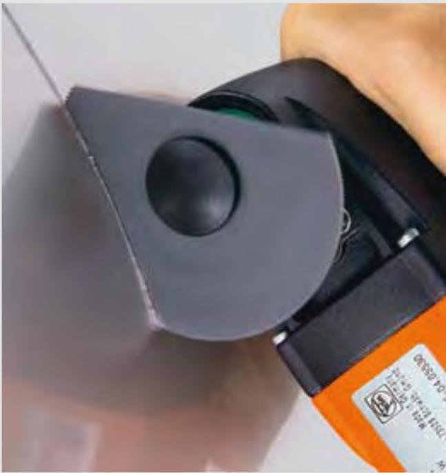
採用高速鋼(HSS)扇形鋸片能夠在無毛刺、無扭曲的條件下對厚度最高為1 mm的金屬板材和塑膠板材進行切割，不需要後道補充工序。就是在拐角區域也可通用。
