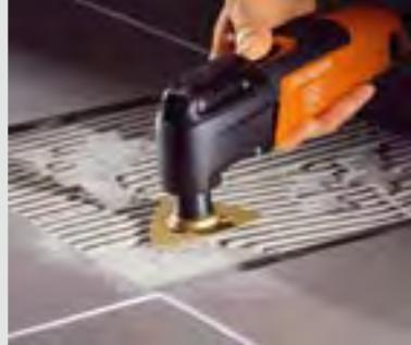
硬金屬打磨鉸是鋪設瓷磚時的萬用配件：它可用於平滑瓷磚粘膠、打磨瓷磚邊沿以及保證提供一個平整的基底。
