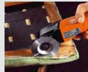
沉頭高速鋼(HSS)鋸片既省力，又能保護沙發—因為固定夾可方便地除去，不必採用鉗子拔除。
