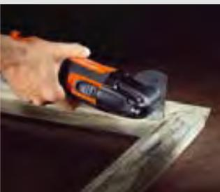
利用高速鋼(HSS)扇形鋸片即使是很舊、很老的窗子您也可對其進行完美的整修—您甚至可毫不費力地對各角落進行加工處理—利用這一工具可省去費時的加工工序。
