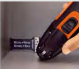
利用E型精確鋸片您可在櫃壁和架壁上方便地建立電線入口、插座以及水管連接位置—這一工作的實施不需要進行耗時費力的櫃子或架子拆卸工作。
