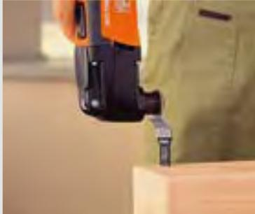
利用通用E型精確木鋸片切割深度最大可達60 mm。
