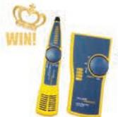
IntelliTone Pro 探頭可測試每根導線端到端的連通性（由LED1-8號燈作指示）。即使機房內有多捆線纜，檢測接線問題也能得心應手。
