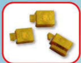
Scotchlok™ 211 修復接線端子 - 在不中斷連線的情況下, 修復並替換有問題的接線子, 也可用於正常的兩線接續 - 適用線徑: 0.4-0.9mm - 最大外徑: 2.08mm
